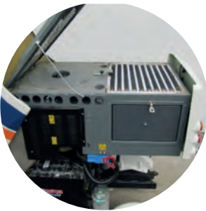
Filteranlage PM10 mit Gewebefilter und elektrischem Filterschüttler
